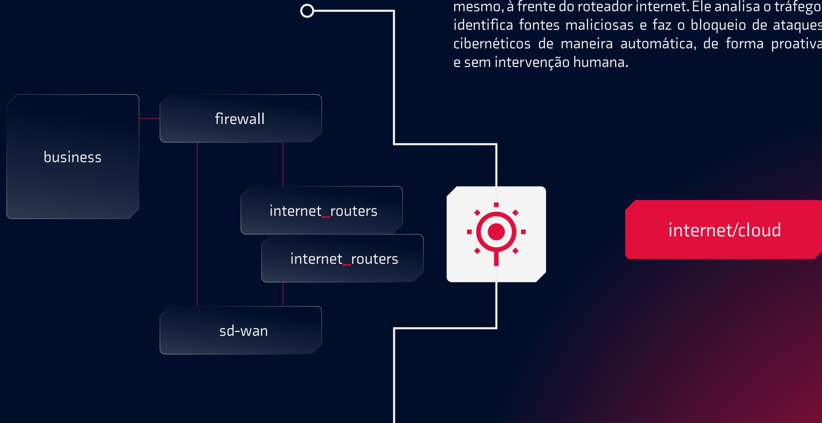
Composto por Hardware e Software, o NetSensor Magic é instalado na **borda da rede, à frente do seu Firewall** e, até mesmo, à frente do roteador internet. Ele analisa o tráfego, identifica fontes maliciosas e faz o bloqueio de ataques cibernéticos de maneira automática, de forma proativa e sem intervenção humana.
